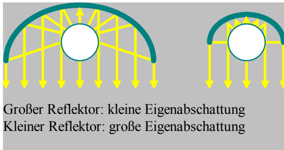
Bild 3: Abschattung durch Leuchtstofflampen
